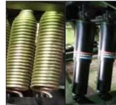
Динамически настраиваемая верхняя подвеска с пружинными рессорами и гидравлическими амортизаторами поглощает даже самые сильные вибрации, возникающие из-за разбалансировки вследствие неравномерного распределения белья, и обеспечивает бесшумную работу машины. Никакие особые требования к основанию площадки, на которую производится установка, не предъявляются. Машина может быть установлена на любом полу, способном выдержать ее собственный вес.
