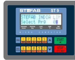
Машины оснащаются ЖК-дисплеями с экранными кнопками или сенсорными дисплеями, которые обеспечивают внесение изменений в параметры технологического процесса, а также отображение информации об управляющих сигналах, настраиваемых в зависимости от времени, и результатах диагностических проверок. Полностью настраиваемая система, не менее 30 программ со встроенным управляющим ПО, обеспечивающим выгрузку только по завершении цикла. **Это обеспечивает интуитивно понятное управление**
