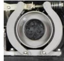
Мощный электропневматический / электромагнитный тормозной механизм автоматически приводится в действие при остановке машины. Мгновенно активируется в момент совмещения люка внутреннего барабана с люком внешнего барабана. Оснащен саморегулирующимися тормозными колодками. Простое регулирование давления в тормозной системе. Устойчивая к отказам конструкция.
