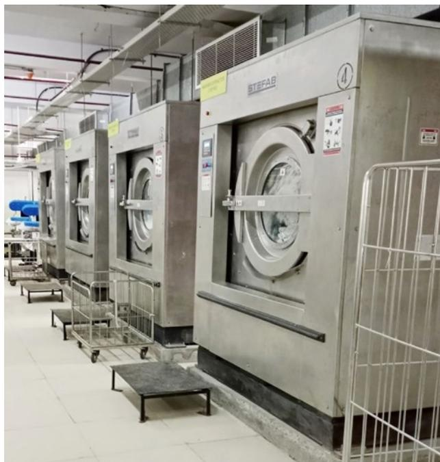
стирально-отжимной машины — ее номинальной загрузки. Дело в том, что десятилетия назад было принято определять ее в килограммах, как объем внутреннего барабана машины в литрах, деленный на 10. Машина с объемом барабана (не бака!) в 220 литров считалась 22-х килограммовой.
