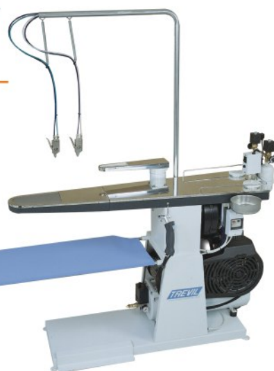
Пятновыводной стол с паровым пистолетом, такой как TREVIL MINI SPOTTY.
