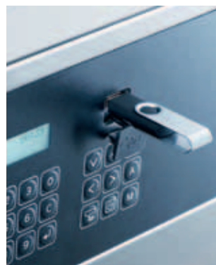
USB-интерфейс для быстрого обновления программ
