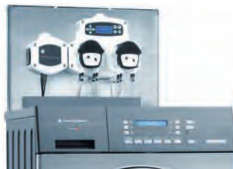
Простое дозирование с помощью устройства подачи жидкого моющего средства
