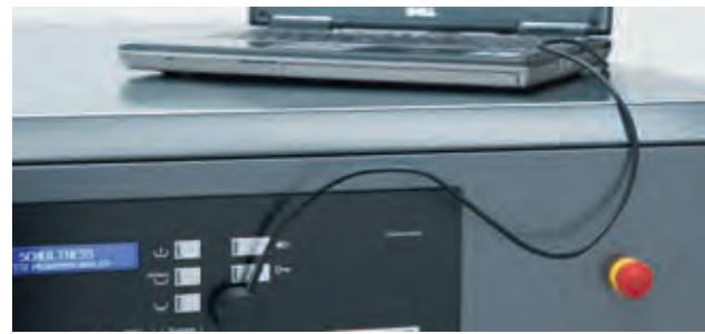
Компьютерный интерфейс для упрощения программирования циклов стирки
