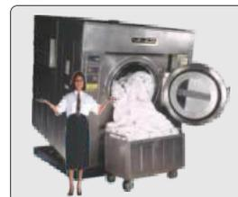
Машины с загрузкой 120 кг оснащаются гидравлической системой опрокидывания, которая позволяет выгружать все белье из барабана в тележку менее чем за 30 секунд. При этом один оператор может обслуживать до 4 машин. **Такая система позволяет предотвратить растягивание и разрыв белья, а также обеспечивает огромную экономию времени и трудозатрат.**
