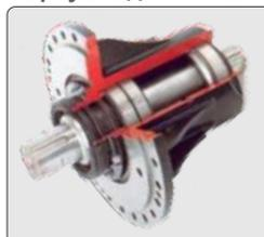
В корпусе установлены широкие роликовые подшипники, имеющие большую контактную площадь для более эффективного распределения динамических нагрузок. Все подшипники заправлены необходимым количеством смазочного материала и герметично закрыты. Самосмазывающиеся двойные уплотнения водного контура и уплотнения подшипников разделены между собой воздушным промежутком. **Благодаря этому предотвращается контакт воды с подшипниками.**
