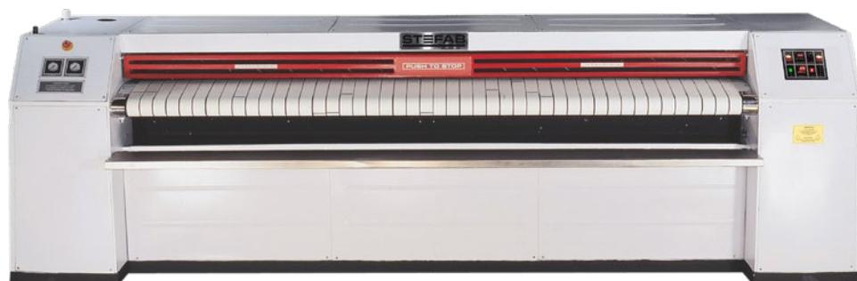
ширина вала понятны из наименования модели) имеет массивную мульду с масляной ванной, в которую погружены ТЭНЫ. Масло значительно повышает теплоемкость мульды и тем самым обеспечивает высокую производительность и качество глажения белья. Более крупные модели СТЕФАБ (FRE 53-300 и FE 83-330) имеют ещё и собственную помпу, которая обеспечивает циркуляцию термомасла, что еще больше улучшает потребительские свойства машины.
