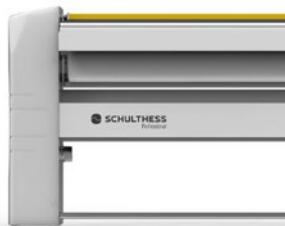
алюминиевая гладильная поверхность в принципе (при прочих равных условиях) быстрее реагирует на изменения подачи белья и лучше «держит» заданную температуру поверхности. Именно такую бескомпромиссную конструкцию имеют гладильные катки Шультесс (Schulthess) MSI 25/100, MSI 30/140, MSI 30/160 и MSI 30/200 с размером вала от 1 до 2 метров. Но обратной стороной совершенства машин, как всегда, является их цена...
